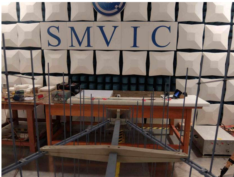
汽车零部件辐射抗扰度测试
