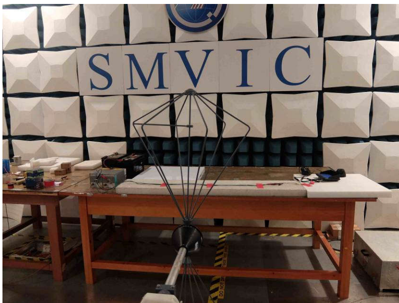
汽车零部件辐射骚扰测试
